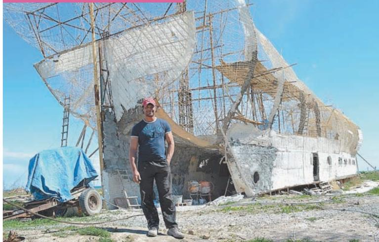
Корабль из... бетона строит крымчанин Виктор Скалета. Громадина (50 м по килю, высота до 4-й палубы - 15 м) - точная копия старинного британского судна «Повелитель морей». Бетонные корабли тяжелее железных, зато дешевле. «Далеко я на нём не заплыву, но вдоль берега ходить можно», - говорит Виктор. Фото «АиФ-Крым»
