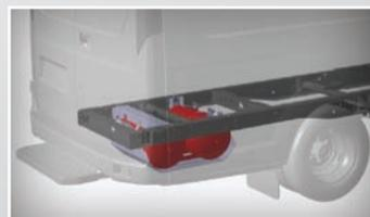
Оснащение газобаллонным оборудованием
