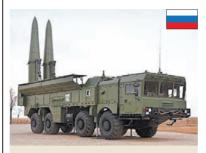
Оперативно-тактический ракетный комплекс Сухопутных войск «Искандер-М». Дальность стрельбы до 500 км. Возможно ядерное и обычное оснащение. Для защиты ракеты от средств ПРО используется активное маневрирование.
