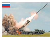
Реактивная система залпового огня «Торнадо-С» – модернизированная в 2017 г. 300-миллиметровая РСЗО «Смерч». Один залп может поразить площадь до 67 га. Обладает головными частями ракет, наводимыми по ГЛОНАСС.
