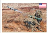
Противотанковый ракетный комплекс «Джавелин» - ПТРК 3-го поколения. Благодаря инфракрасной головке самонаведения позволяет уничтожать танки в режиме «выстрелил и забыл».
