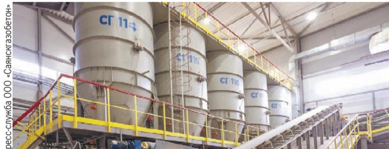
Силикатный кирпич производится из смеси песка, извести и воды, прессуется под большим давлением и проходит автоклавную обработку.
