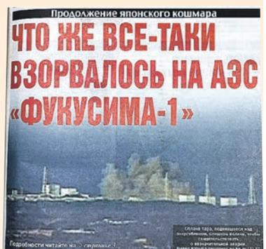
того, что «самовар», образно выражаясь, выкипел. Активная зона перегрелась, частично расплавилась. В лучшем случае образовавшийся пар стравили внутрь защитной бетонной оболочки, которая окружает реактор. И рванула она - эта оболочка, не выдержав избыточного давления. В худшем - сорвало крышку с самого реактора. В обоих случаях, к сожалению, в атмосферу попал радиоактивный пар - тот, который контактировал с расплавленными тепловыделяющими элементами.
