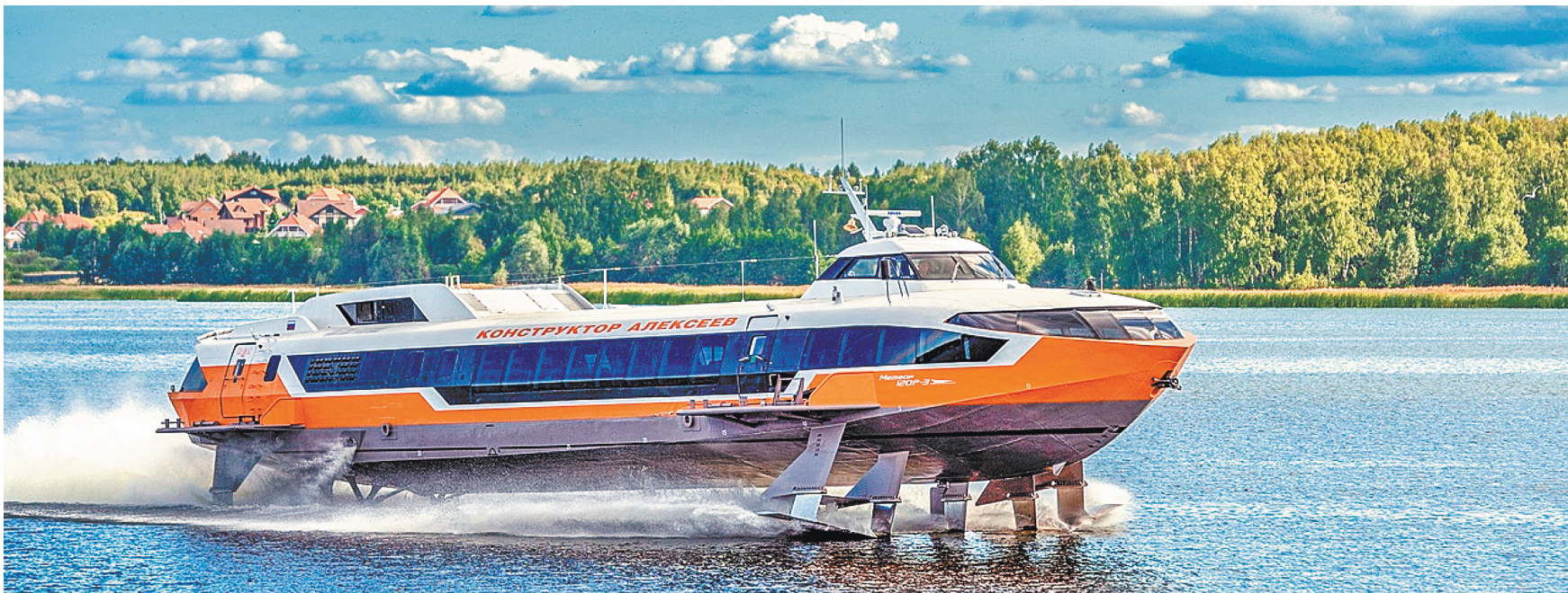
Когда «Метеор» «встает на крыло», то поднимается над поверхностью воды больше чем на метр.
