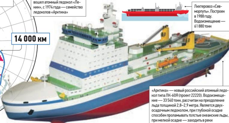
«Арктика» — новый российский атомный ледокол типа ЛН-60Я (проект 22220). Водоизмещение — 33 540 тонн, рассчитан на преодоление льда толщиной 2,8–2,9 метра. Является двухосадочным ледоколом, при глубокой осадке способен проламывать толстые океанские льды, при мелкой осадке — заходить в реки
