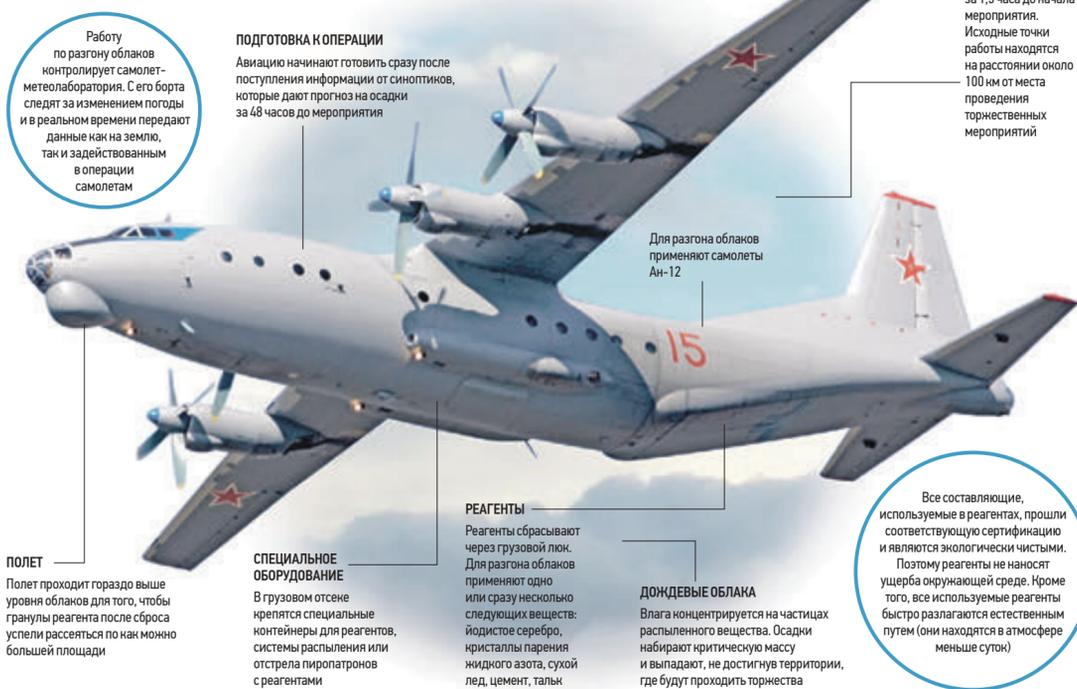
Работу по разгону облаков контролирует самолет-метеобюро. С его борта следят за изменением погоды и в реальном времени передают данные как на землю, так и задействованным в операции самолетам
