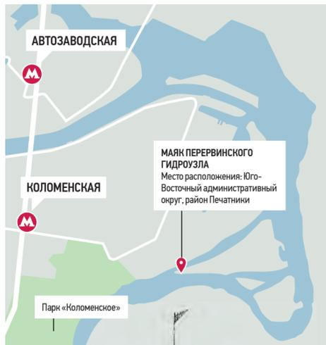
Маяк был построен после реконструкции Перервинского гидроузла в 1930-х годах, когда здесь возвели новую плотину, шлюзы для прохождения крупных судов и дамбы.
